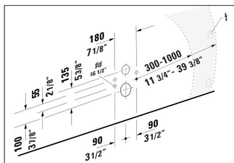
Ajuste la altura del inodoro basándose en la posición del desagüe de acuerdo con el dibujo técnico del inodoro.
