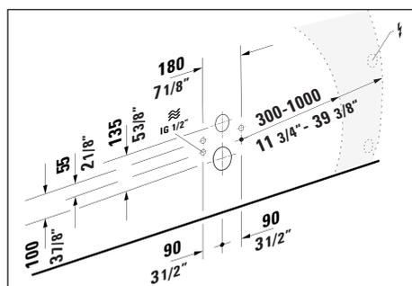
Régler la hauteur de la cuvette sur la base de la position de l'évacuation, conformément au schéma technique de la cuvette.
